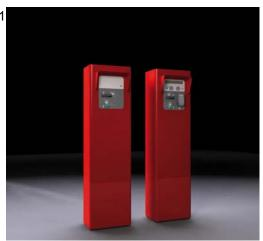
Die Kapazität des Ticketspenders umfasst ca. 6000 Karten. Ein optischer Sensor überwacht die Kapazität. Nachdem der Parkschein über das Kartenentnahmefach entnommen wurde öffnet die Schranke und gewährt die Zufahrt zum Parkraum. 2 Induktionsschleifen kontrollieren hierbei die Anwesenheit und die Zufahrt.
